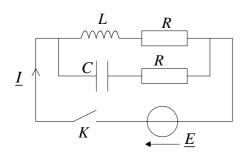
On considère un appareil inductif (modélisé d'un point de vue électrocinétique par une résistance R et une inductance L), alimenté sous une tension sinusoïdale au travers d'un interrupteur K devant être manoeuvré très souvent .
